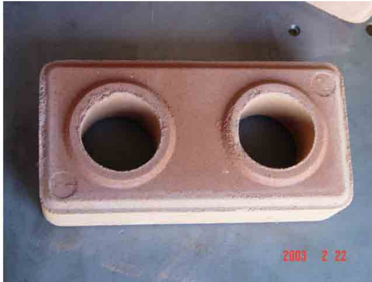
Foto 2 – detalhe dos furos com o encaixe saliente, que fica para cima durante o assentamento, do tijolo de solo-cimento com 6,25 x 12,5 x 25 cm.
