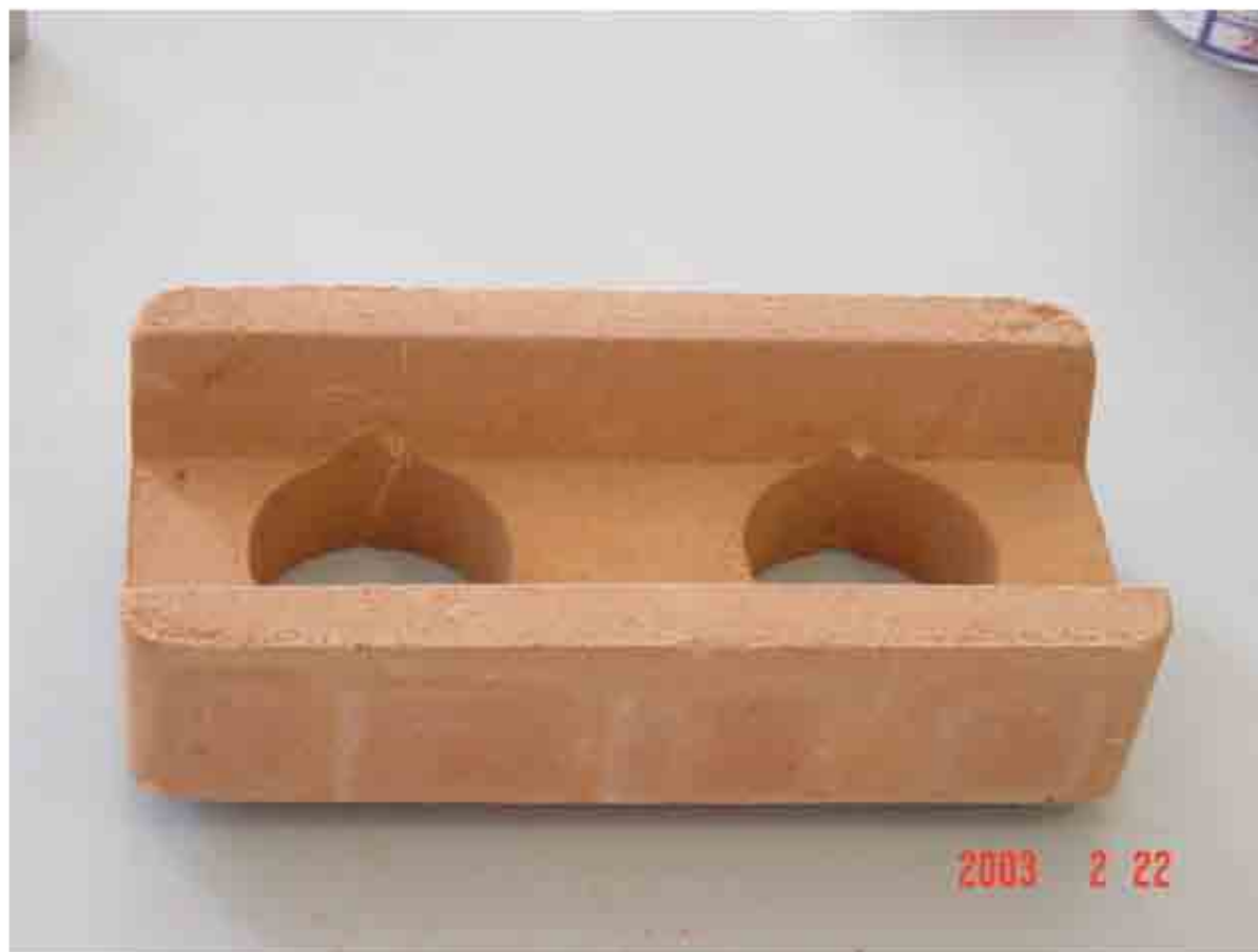
Foto 1 – tijolo de solo-cimento tipo canaleta para a execução de vergas e cintas de amarração.
