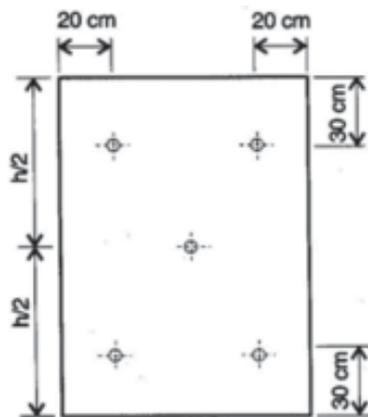
Posicionamento dos termopares na superfície do corpo-de-prova
